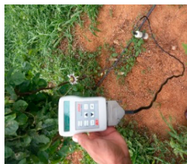
Figura 2: Realização de leitura com sonda FDR, PR2/6. Foto: Nunes, J.M.G.2022.
