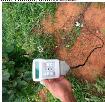
Figura 2: Realização de leitura com sonda FDR, PR2/6. Foto: Nunes, J.M.G.2022.
