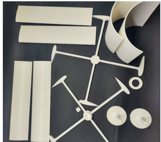
Figura 3 - Partes da hélice eólica confeccionada em impressora 3D.
