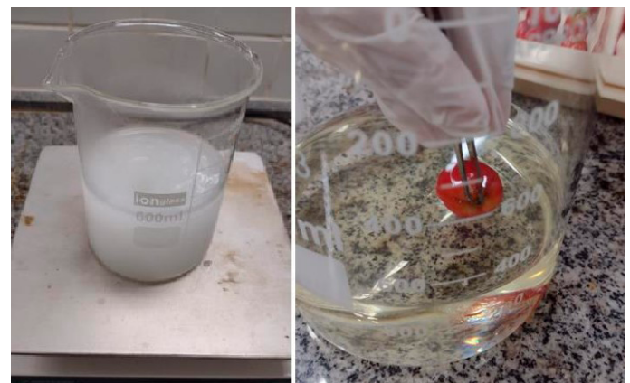
Figura 2: Produção dos biofilmes sob agitação e aquecimento.
