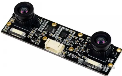
Figura 4 - Câmera estéreo IMX219 da Waveshare.
