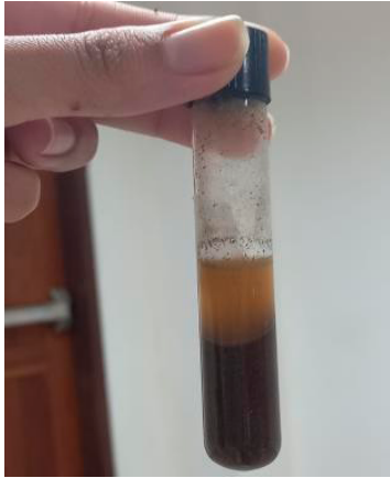
Figura 3 - Amostra após passar pela centrifuga separando a amostra da farinha da água
