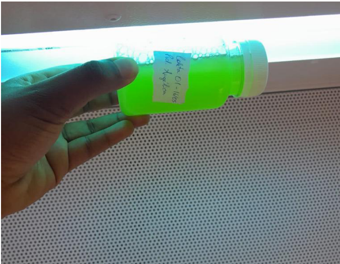
Figura 6 - Amostra coletada confirmando a presença de E. coli , após ser exposta à luz fluorescente.
