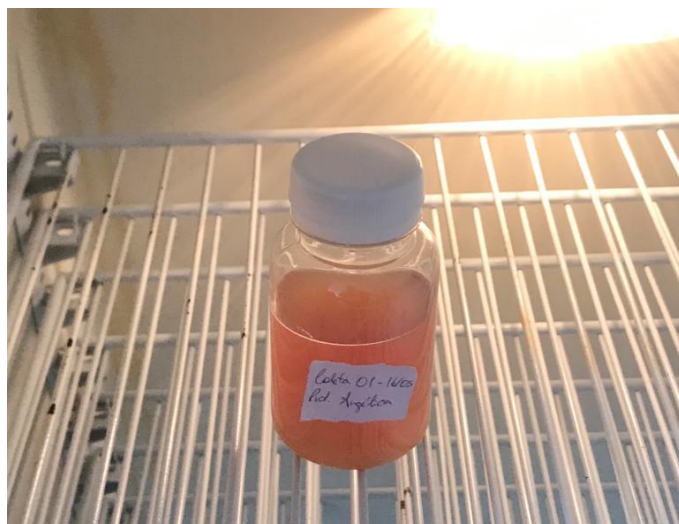
Figura 5 - Amostra coletada confirmando a presença de bactérias coliformes após a mudança da cor púrpura para a tonalidade amarelada.
