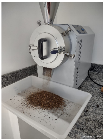
Figura 1- Imagem fotográfica do processo de moagem das casca de café me moinho de facas.
