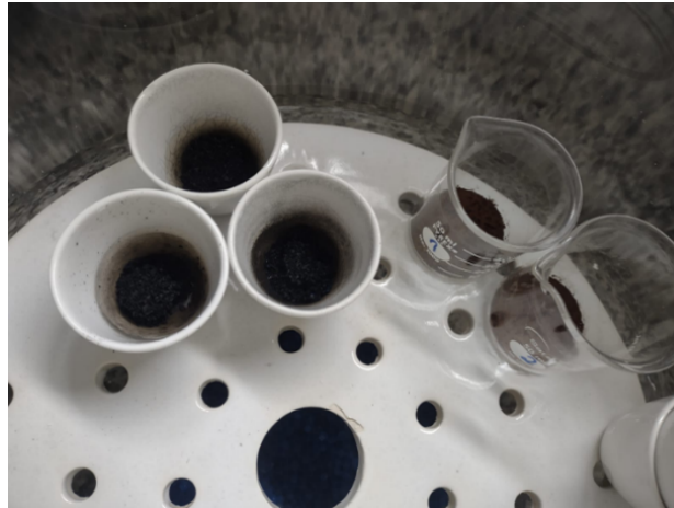
Figura 2 - Imagem fotográfica das amostras de casca de café após o procedimento para determinação do teor de cinzas.
