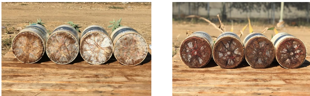
Figura 1 - Crescimento radicular de feijão guandu e sorgo sob as densidades 1.1 \text{ g.cm}^{-3} , 1.3 \text{ g.cm}^{-3} , 1.5 \text{ g.cm}^{-3} , 1.7 \text{ g.cm}^{-3} respectivamente aos 60 dias.
