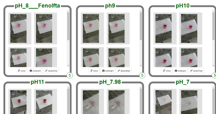
Figura 02 - Classificações de imagens/colorações e pH na plataforma ML4K.
